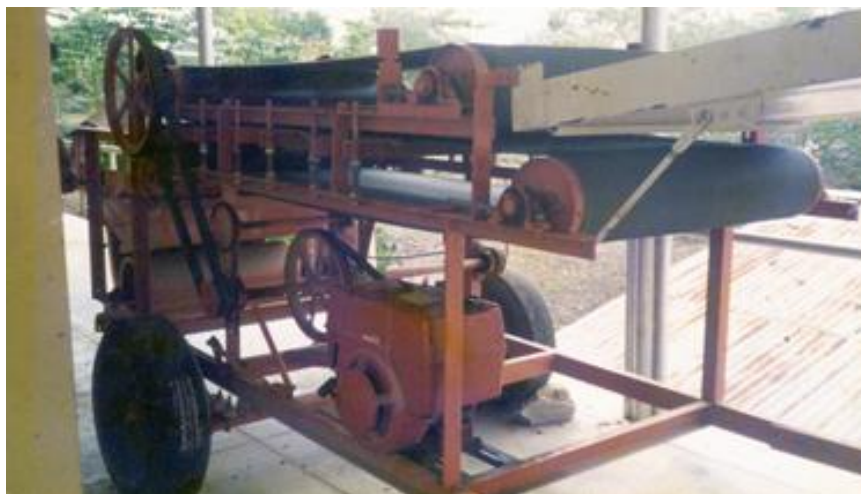
Foto 31 Máquina trilladora múltiple, para el descascarado de la cápsula De sachá inchi
