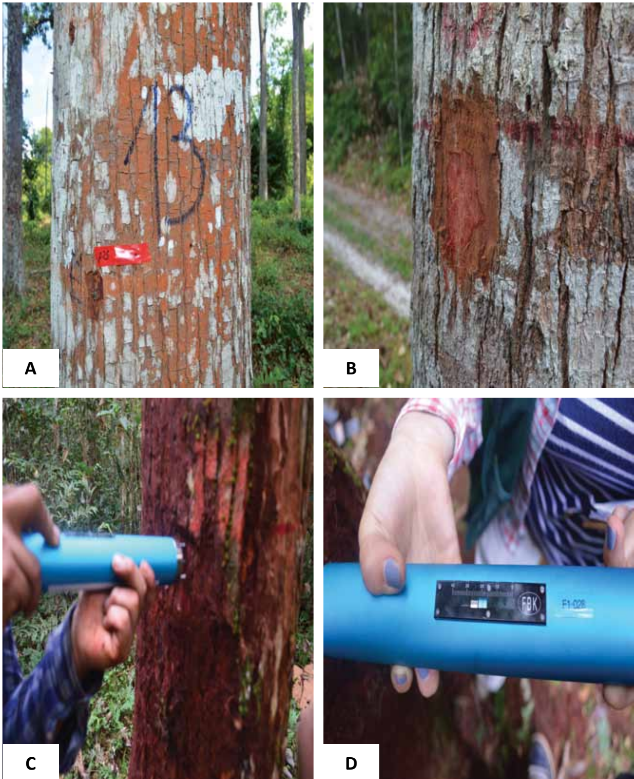
Figura 9. Proceso para el uso del Pilodyn. A. Ubicación y codificación del árbol.
