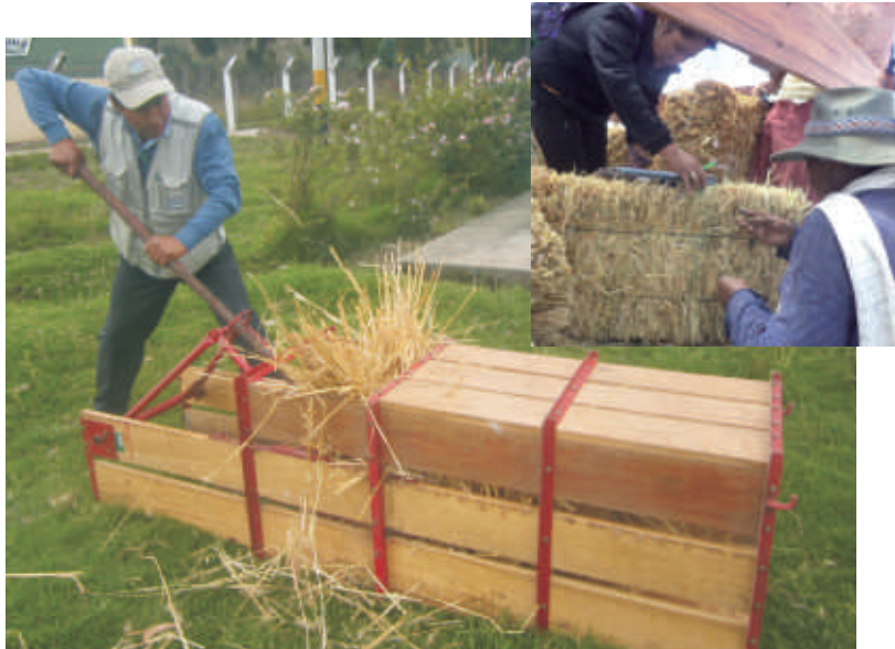
Fotos 14 y 15. Empacadora manual, accionada por una palanca para el compactado del heno.
