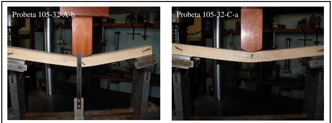
Figura 15: Plasticidad en las Probetas de Flexión Estática
