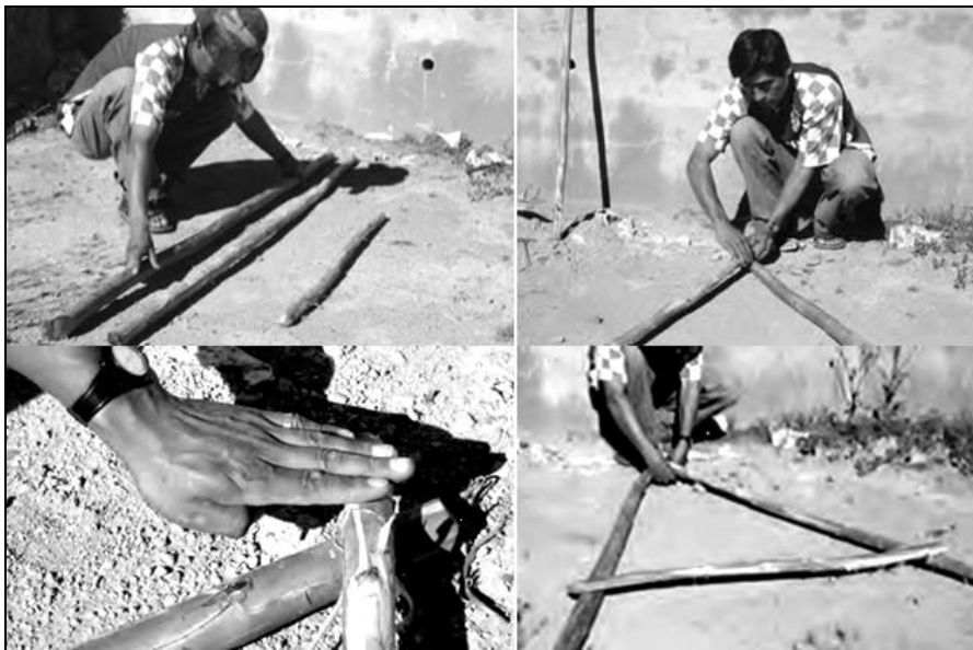
Figura 48. Materiales y proceso de construcción de un nivel en "A"
