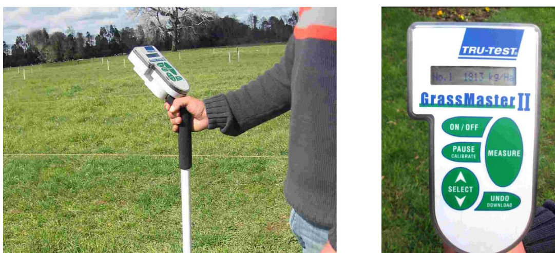
Figuras 63 y 64. Capacitómetro o bastón electrónico y Microprocesador que transforma el valor de la capacitancia electrónica del forraje en disponibilidad de materia seca. Tomado de Teuber y otros (2007)
