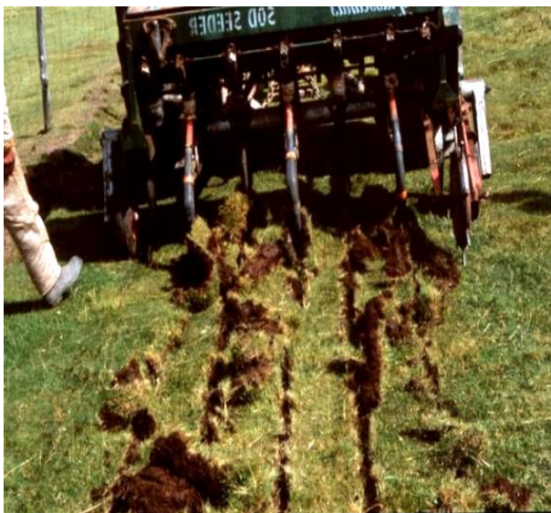
Figuras 92 y 93. Intersiembrado con máquina sembradora Sod Seeder. Campos de pastos mejorados de IVITA-La Raya-Cusco. Foto R. Farfán
