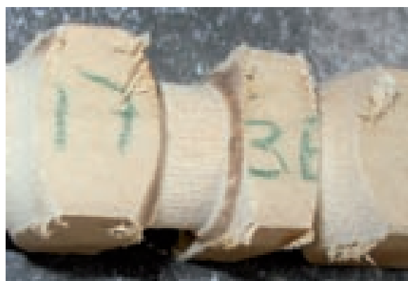
FOTO N° 10: PROBETA DE CAPIRONA CON GRANO ASTILLADO Y ZONAS QUEMADAS, EN EL ENSAYO CON 15° Y 2820 r/min.
