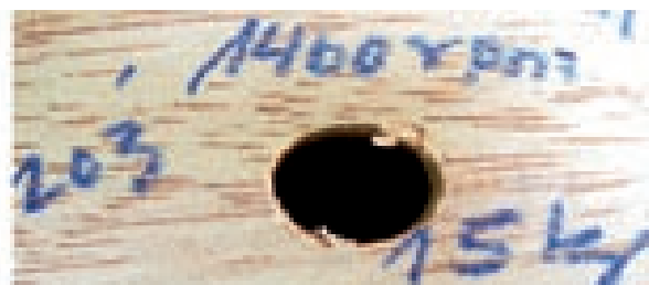
FOTO N° 08: ENTRADA DE TORNILLO EN CAMPO ABIERTO CON 15 kg. DE CARGA Y DOS VELOCIDADES DE GIRO. EL GRANO ASTILLADO ES EL DEFECTO PREDOMINANTE.
