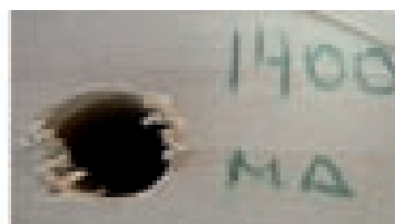
FOTO N° 15 : ENTRADA DE CAPIRONA CON 30 kg. DE CARGA, 1400 r/min. Y DOS TIPOS DE BROCAS. EL GRANO ASTILLADO ES EL DEFECTO PREDOMINANTE EN LA PERFORACIÓN CON BROCA PARA MADERA.
