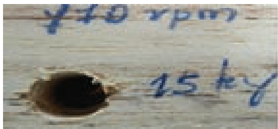
FOTO N° 06: ENTRADA DE PINO CHUNCHO CON 15 kg. DE CARGA Y DOS VELOCIDADES DE GIRO. EL GRANO ASTILLADO ES EL DEFECTO PREDOMINANTE.
