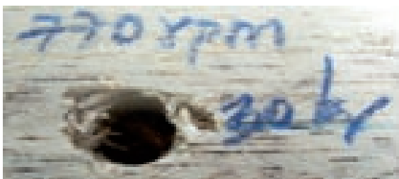
FOTO N° 07: ENTRADA DE PINO CHUNCHO CON 30 kg. DE CARGA Y DOS VELOCIDADES DE GIRO. EL GRANO ARRANCADO Y ASTILLADO SON LOS DEFECTOS PREDOMINANTES.
