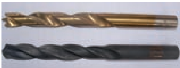
FOTO N° 02: BROCAS PARA MADERA Y METAL UTILIZADAS EN EL ENSAYO DE TALADRADO.
