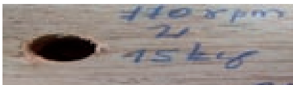
FOTO N° 12 : ENTRADA DE TORNILLO EN FAJA DE 30 m. CON 15 kg. DE CARGA Y DOS VELOCIDADES DE GIRO. EL GRANO ASTILLADO ES EL DEFECTO PREDOMINANTE.
