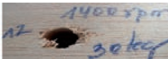
FOTO N° 11 : ENTRADA DE TORNILLO EN FAJA DE 5 M. CON 30 KG. DE CARGA Y DOS VELOCIDADES DE GIRO. EL GRANO ASTILLADO Y ARRANCADO SON LOS DEFECTOS PREDOMINANTES.
