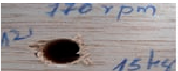
FOTO N° 10: ENTRADA DE TORNILLO EN FAJA DE 5 m. CON 15 kg. DE CARGA Y DOS VELOCIDADES DE GIRO. EL GRANO ASTILLADO ES EL DEFECTO PREDOMINANTE.
