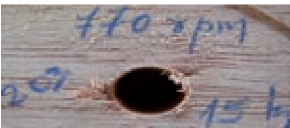
FOTO N° 08: ENTRADA DE TORNILLO EN CAMPO ABIERTO CON 15 kg. DE CARGA Y DOS VELOCIDADES DE GIRO. EL GRANO ASTILLADO ES EL DEFECTO PREDOMINANTE.
