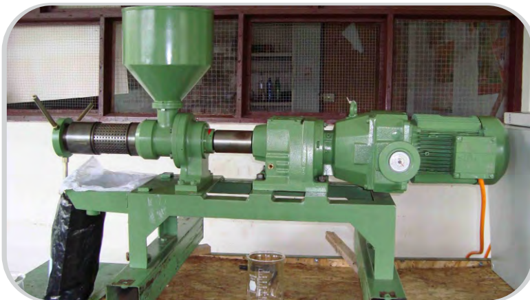
Figura 68. Prensa extractora de aceite marca KEK modelo P0020 – Fabricación Alemana
