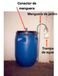
Sellado del bidón de plástico y colocación de una trampa de agua para la extracción de los gases de la fermentación
