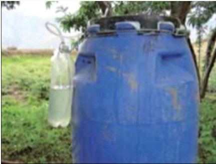
Sellado del bidón de plástico y colocación de una trampa de agua para la extracción de los gases de la fermentación
