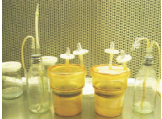
Foto 8. Comparación de envases RITA y contenedores alternativos
