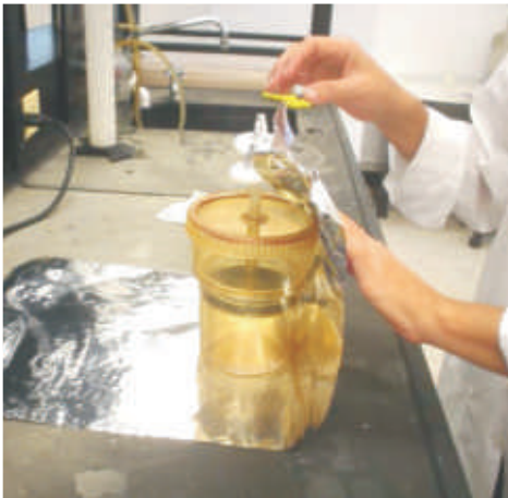
Foto 6. Preparación de envases RITA® para ingreso al autoclave.
