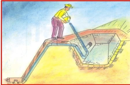
Figura N° 6: Operación para el funcionamiento del sifón
