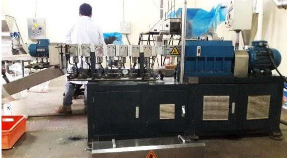
Extrusor Inbramaq Modelo PQ DRX-50 (Brasil) Doble tornillo corrotante
