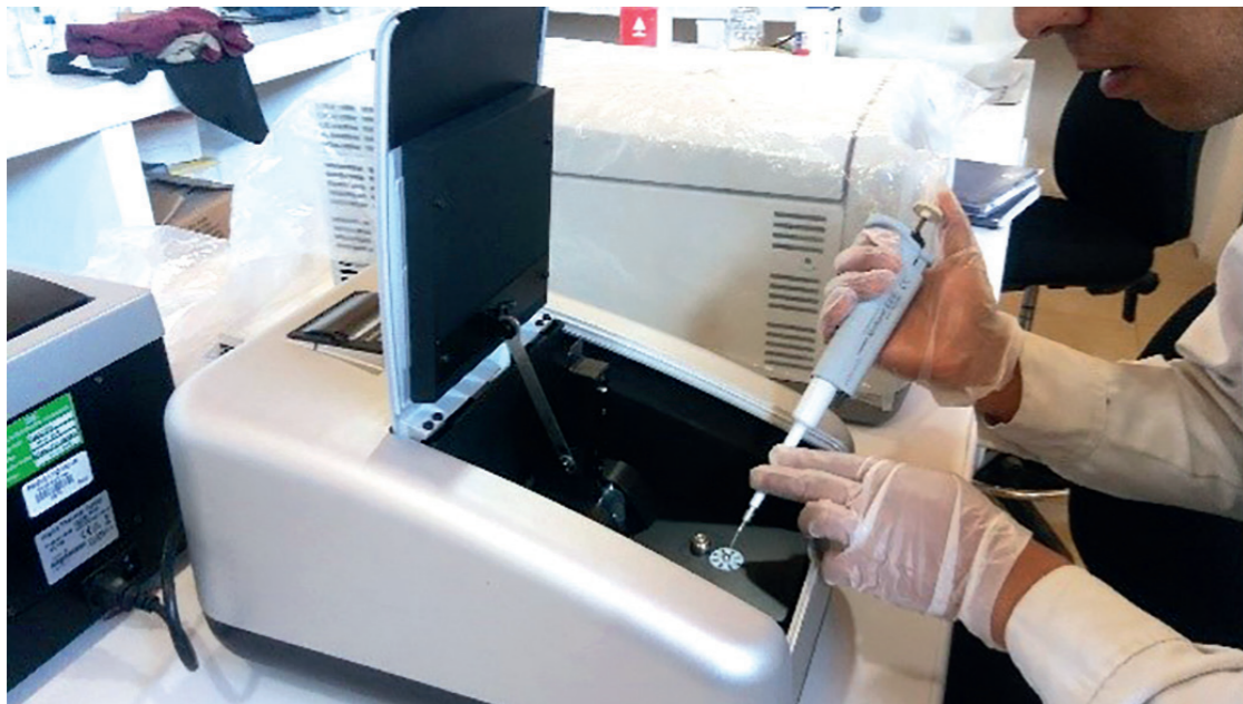
Figura 25. Evaluación de la concentración ADN plasmídico en espectrofotómetro.
