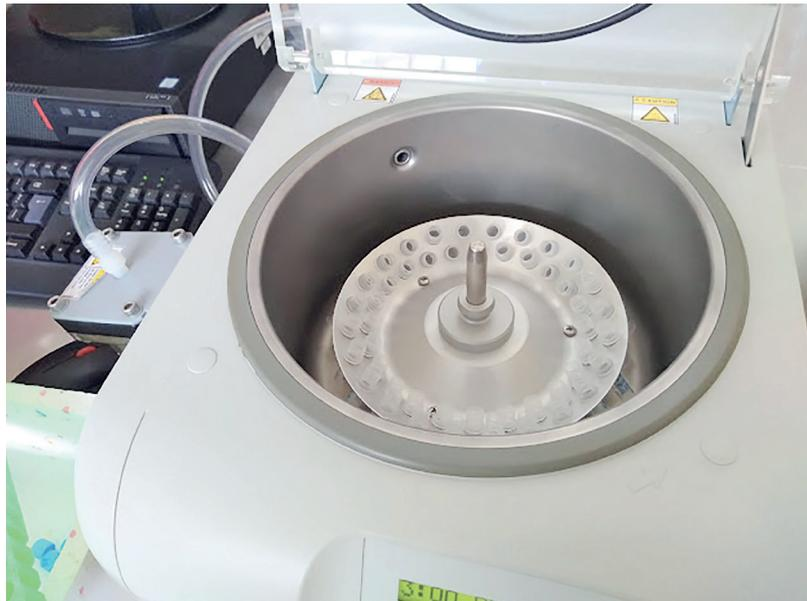
Figura 26. Secado de las muestras de ARN de quinua a temperatura ambiente por tres horas en el equipo SpeedVac®.
