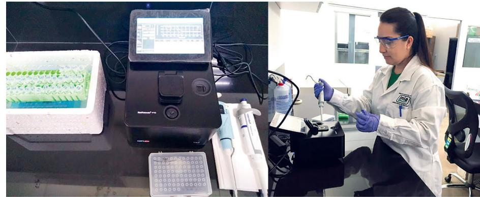
Figura 23. Espectrofotómetro IMPLEN® Nanophotometer® utilizado para cuantificar la cantidad de ARN.
