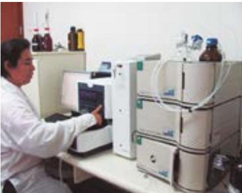
Cromatografía Líquida de Alta Eficiencia (HPLC).
