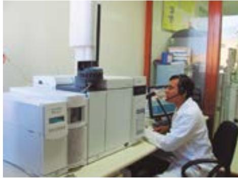
Cromatografía de gases acoplada a espectrometría de masas (GC-MS).
