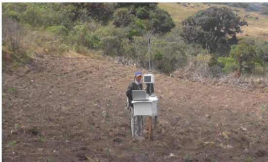
Estación meteorológica automatizada manejada por los productores de ACOBOSPA
