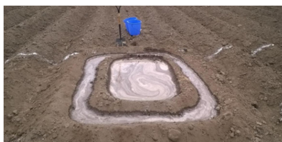
Preparación de la poza de 0.8x12m 2 , para la evaluación de humedad gravimétrica a capacidad de campo en la campaña experimental 2017
