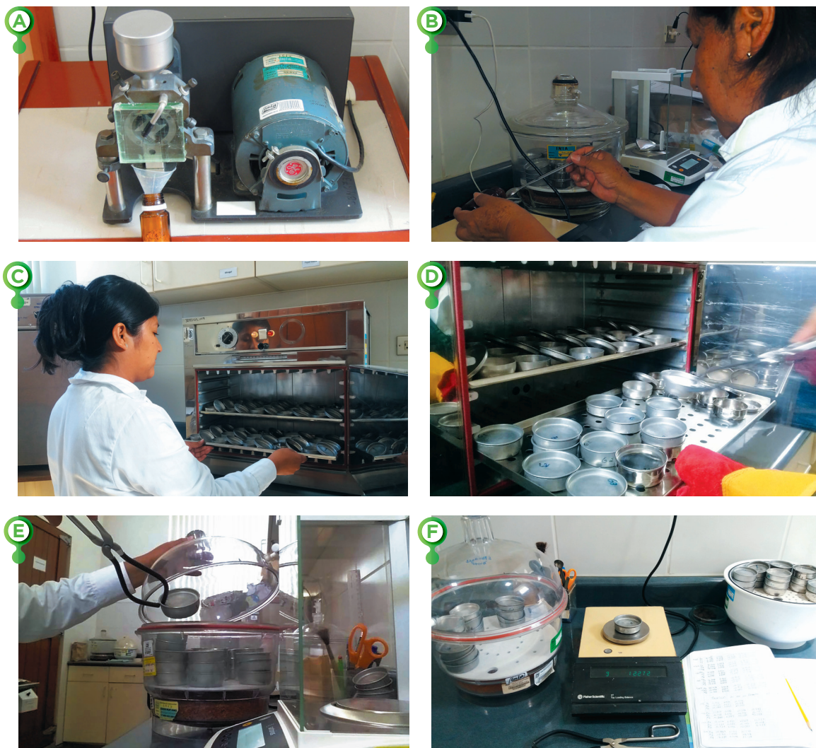
Figura 17. Determinación del contenido de humedad. Molido de semillas (A), pesaje de muestras húmedas (B), determinación de humedad por el método de la estufa a temperaturas de 101 a 105 °C (C) recipientes con semillas molidas salidas de la estufa (D). Muestras de algarrobo en desecador (E), peso seco de muestras de algarrobo (F). Fotos: Fredesvinda Carrillo.
